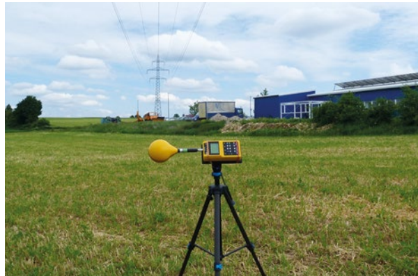
Magnetfeldmessung unter einer 110-kV-Leitung
