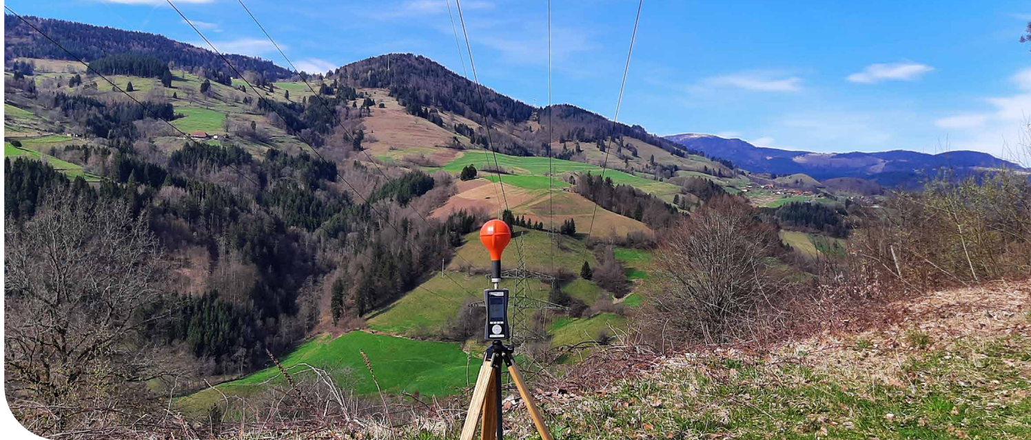
Magnetfeldmessung unter einer 110-kV-Leitung
