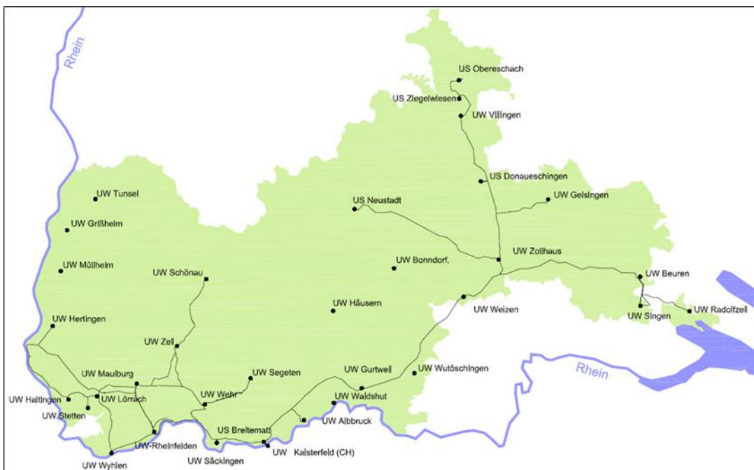
Abb. 1: Netzkarte der ED Netze GmbH (110-kV Ebene), Stand: 24. November 2020
